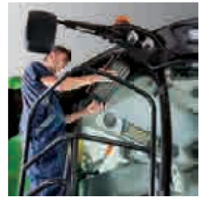
Emplacement pratique des filtres dans la cabine, peu poussiéreux et faciles à nettoyer.
