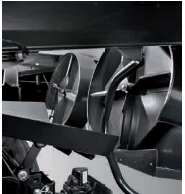
Nouveau convoyeur de menue paille avec glissières métalliques qui orientent la menue paille vers les turbines à 4 pales.
