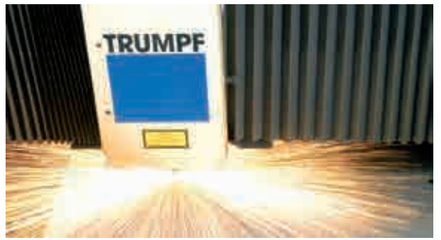
Chaque élément de la structure a été sectionné avec des découpeuses laser, qui en partant du dessin en 3D, aboutissent à la pièce finie.
