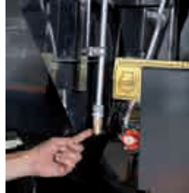
Un compresseur d'air (option) est prévu derrière le groupe des radiateurs. L'installation est munie de 3 sorties, une du côté de la moissonneuse-batteuse et une sur le compartiment moteur.
