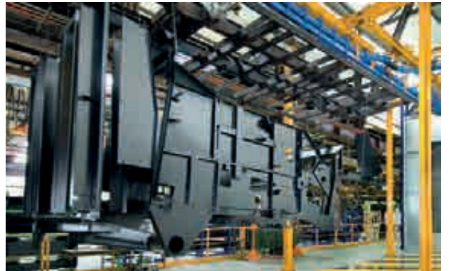
Toutes les pièces peintes de la machine ont été traitées à travers un processus avancé de cataphorèse en immergeant chaque pièce dans des bains composés de 14 cuves qui commencent par le nettoyage, puis la polarisation jusqu'à la phase finale de peinture..
