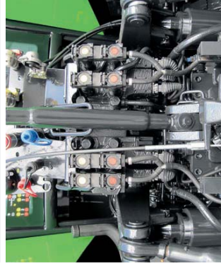
Dans l'accrochage à l'arrière des versions Profiline, la commande d'un distributeur auxiliaire peut être intégrée sur demande.
