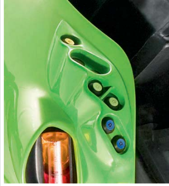
Dans l'accrochage à l'arrière des versions Profiline, la commande d'un distributeur auxiliaire peut être intégrée sur demande.
