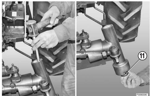
10 - À l'aide d'un mandrin approprié, déposer la bague ou douille (12).
