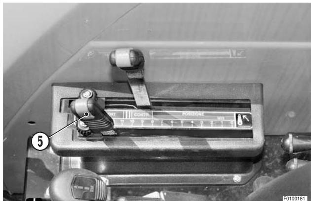
16 - Le relevage devrait commencer à se mettre en mouvement lorsque le levier (5) se trouve en position "4".
