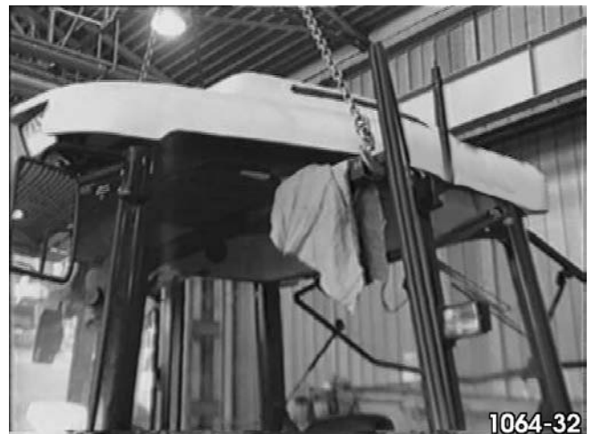
Fig. 16 - Soulèvement de la cabine du tracteur à l'aide d'un palan.
