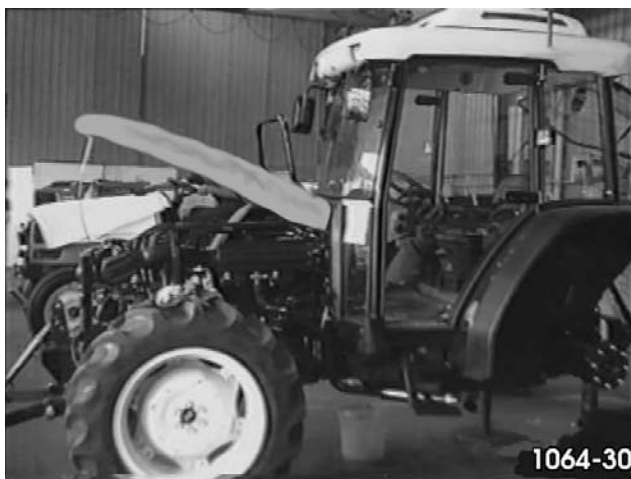
Fig. 15 - Désaccouplement des parties qui unissent la cabine au tracteur.
