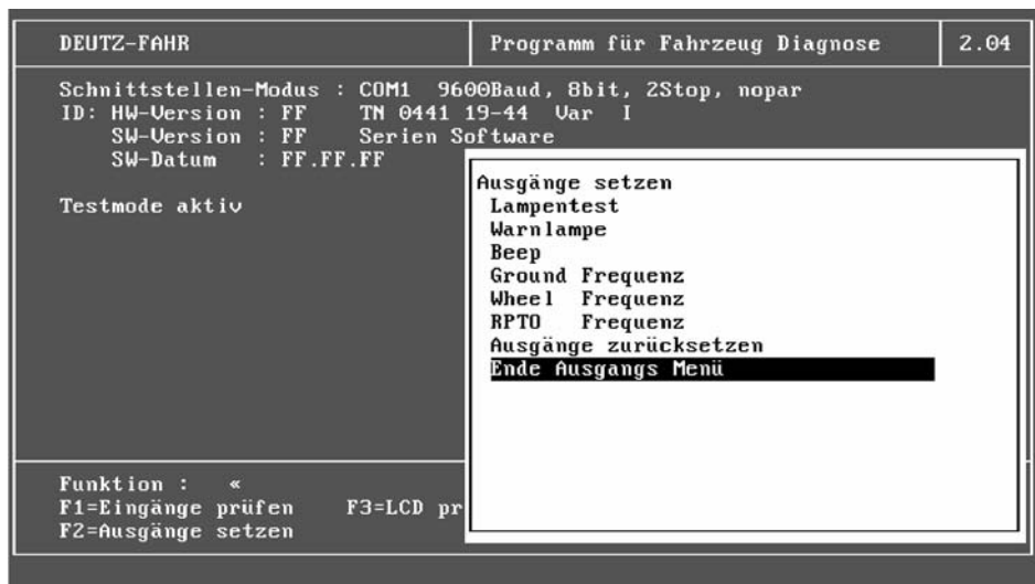
Fig. 57 - Fenêtre Set outputs
