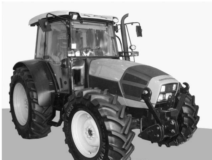
Version avec cabine (la cabine existe en deux versions, avec toit standard ou avec toit haute visibilité - sur demande -) ; la figure montre la version "haute visibilité".
