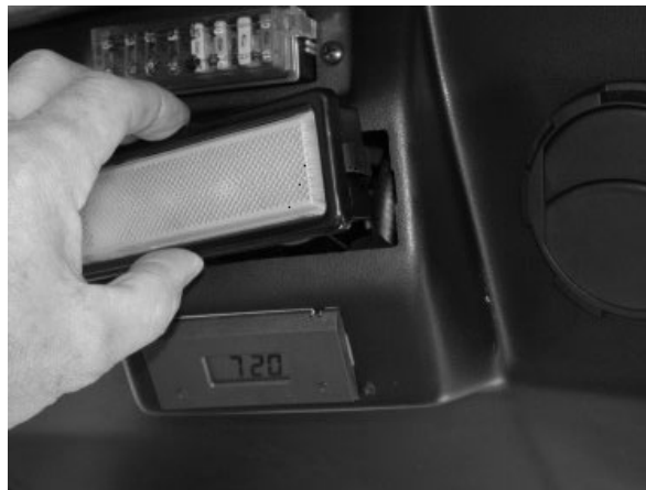
Plafonnier de cabine Pour le remplacement de l'ampoule, sortir le corps du plafonnier en le tirant vers l'extérieur.
