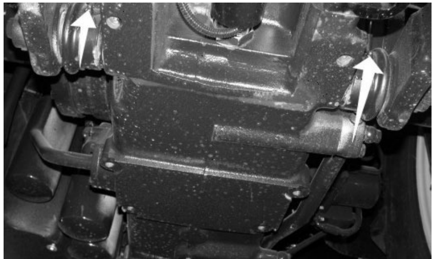
Graisseurs de l'arbre des bras de relevage inférieurs.
