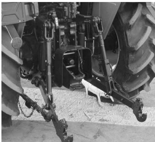
Attelage 3-points avec accouplements mécaniques.
