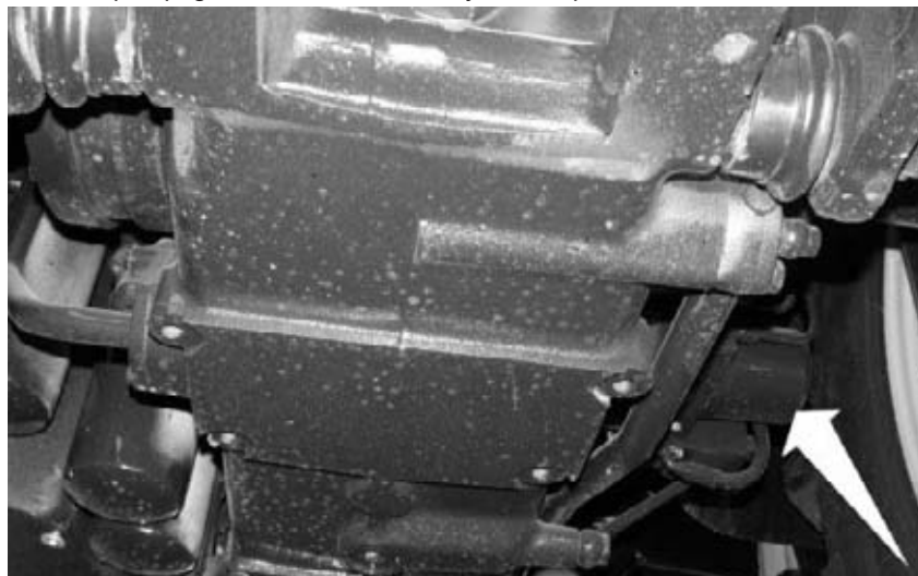
Filtre à huile de la centrale des commandes électrohydrauliques
